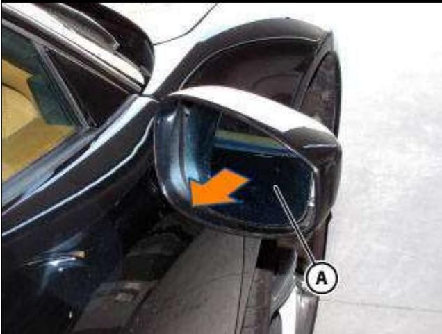
● 在不同位置应用杠杆作用，从车外后视镜壳体拆下玻璃 (A)。
