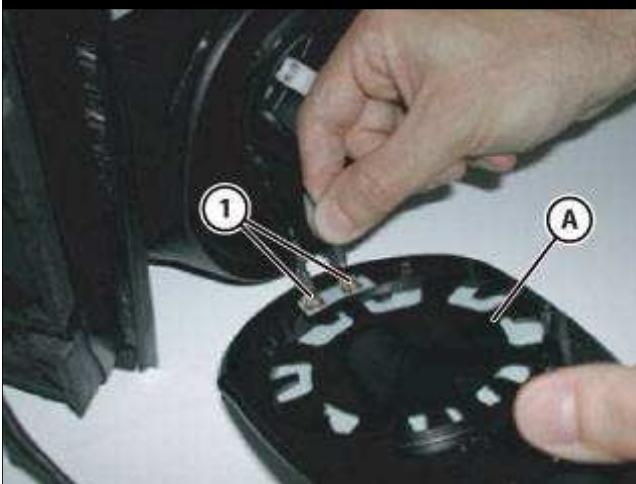
● 将电缆分支 (1) 从后视镜玻璃加热器元件 (A) 上拔下并更换玻璃。
