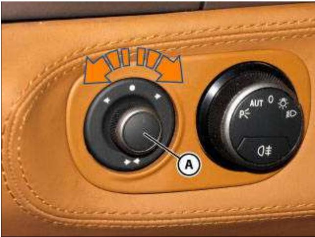
● 在调节之后, 将旋钮 (A) 向后转动  $45^\circ$  至中间位置, 以防意外改变后视镜设置。
